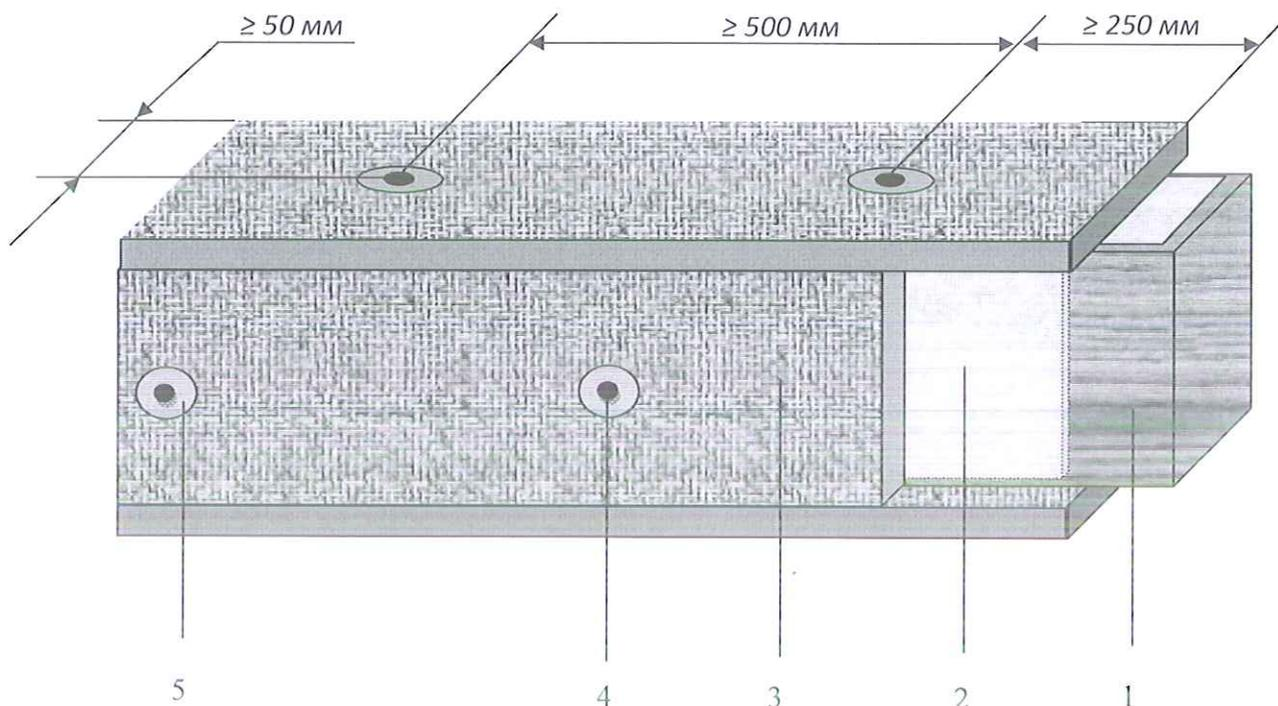
1.- деревянный брус сечением 150x100 мм; 2.- клей CONLIT Glue; 3.- плита из каменной ваты ROCKWOOL CONLIT SL 150; 4.- саморез; 5.- пресс-шайба.
